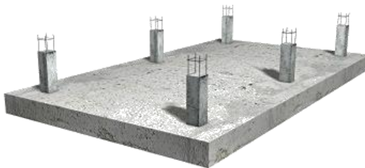
Imagen Nº 17.-Modelo de cimentación mediante losa armada.
